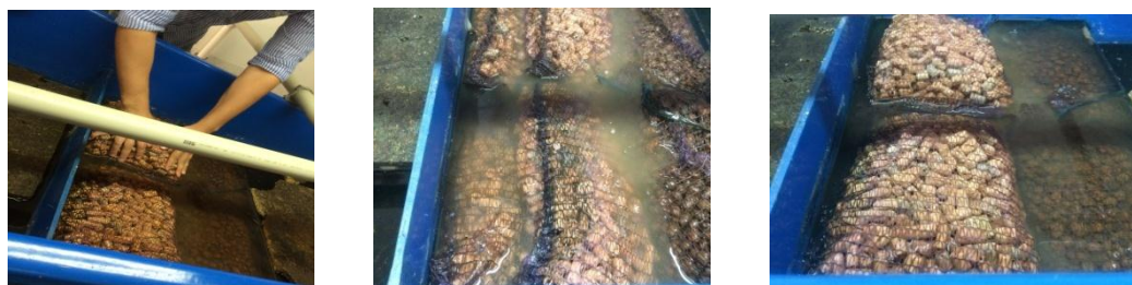
Рисунок 3. Процесс замены импортных наполнителей на органоминеральный биоматериал собственного производства для биофильтраций и очистки воды бассейна действующего опытно-производственного участка «Аквакультуры» по выращиванию осетровых рыб в условиях замкнутого водообеспечения.
