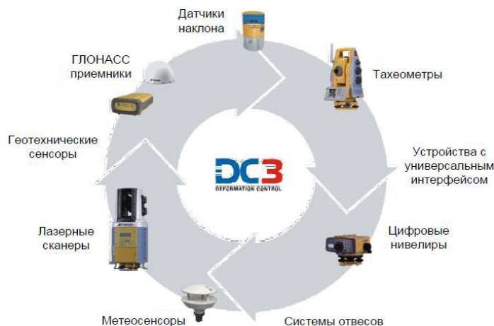
Рисунок 3. Элементы системы DC3 (Deformation Control) наземно-космического мониторинга ГТС
