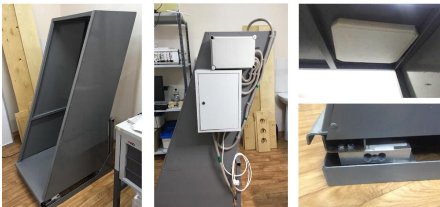
Рисунок 2. Реализованный экспериментальный образец оборудования для удаленного контроля живой массы
