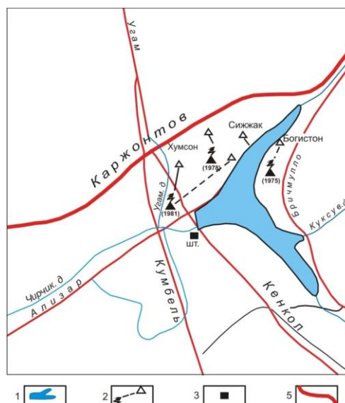
Рис.2. Схема расположения генераторных и приемных пунктов метода ДЭЗ в Чарвакском полигоне: 1-контур Чарвакского водохранилища, 2- генераторная и приемная станция, 3-геофизическая шtolья, 4-разломы [8].
