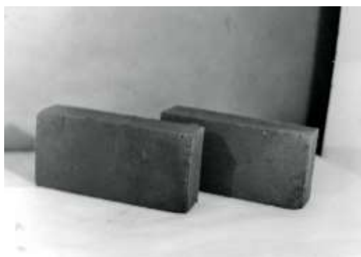
Рис.1. Стеновые кирпичи на основе вяжущего из доменных шлаков и керамзитового заполнителя
